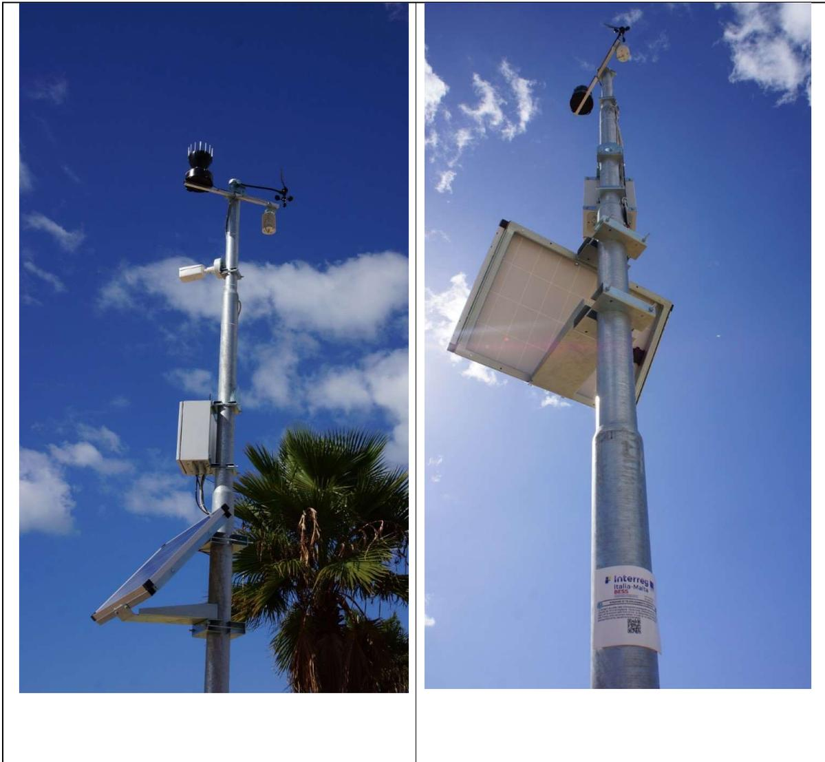
Figura 9.3. Stazione con videocamera e anemometro (Progetto BESS - INTERREG ITALIA MALTA)
