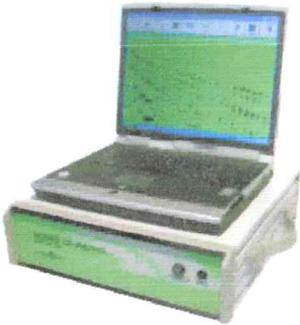
N° 1 Registratore multicanale "AMBROGEO ECHO 12-24/2002" a memoria incrementale, gestito da un microprocessore, con ventiquattro canali di acquisizione simultanea, scale dei tempi variabili e incremento di segnale variabile per ogni canale.
